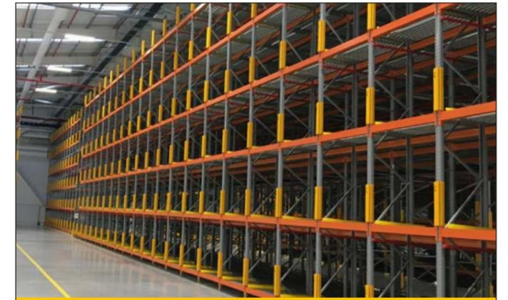
RackGuard también se puede instalar por encima del nivel del suelo para proteger estanterías de daños durante carga y descarga.
